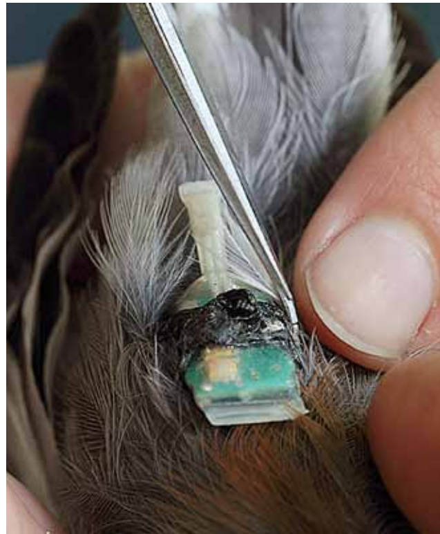
Nærbillede af lyslogger monteret som rygsæk med stropperne omkring benene. Foto: Per Ekberg Pedersen.
