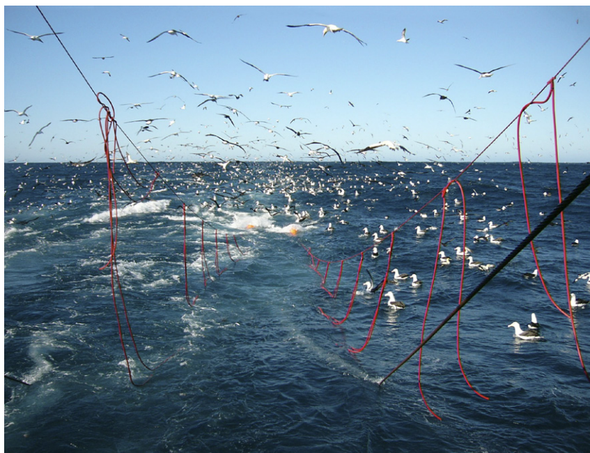
I Sydafrika har man fundet på at slæbe en anden line parallelt med trawllinen, hvorpå der hænger løse liner ned omkring trawllinen. Det er nok til at skræmme fuglene væk fra den farlige zone, så dødeligheden blandt albatrosserne er reduceret med 99 %. Foto: Barry Watkins.
